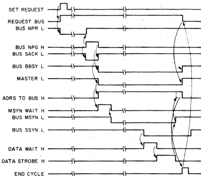
Figure 6-20 M796 Timing Diagram for DAT1
